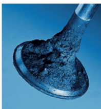
Ablagerungen an Ventilen, geringe Motorleistung.
